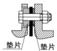
膜片联轴器结构图一：
